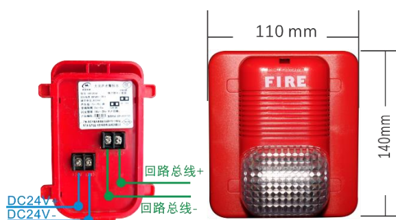
SG8306A 声光报警器接线图 (编址型)
