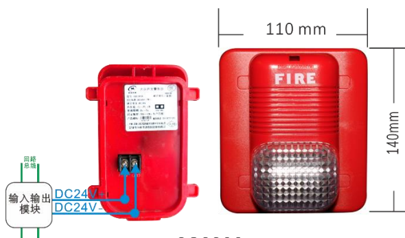
SG8306 声光报警器接线图 (非编址型)
